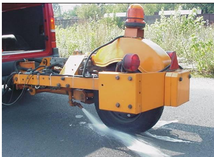
Fot. 11 Przyczepa dynamometryczna SRT-3 podczas wykonywania pomiaru
