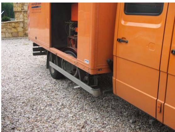
Fot. 13 Urządzenie SCRIM firmy Hansa-Nord-Labor
