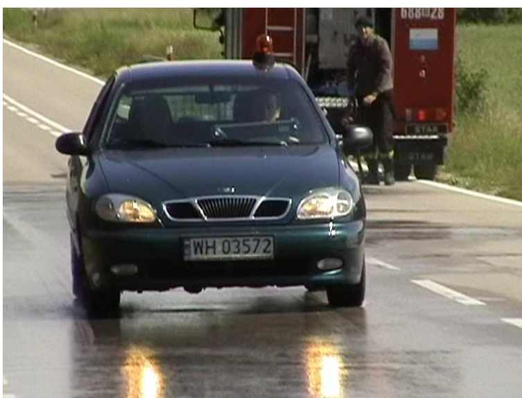
Fot. 15 Samochód w trakcie badania opóźnienia hamowania – odcinki I, II i III
